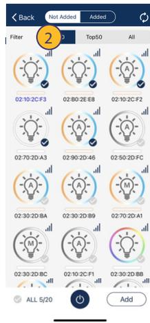
2. Seleccione **Top20**, **Top50** o **Todos** en el filtro de la parte superior de la pantalla para mostrar las luces con la señal Bluetooth más potente.
