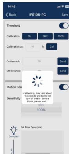
2. Aparecerá un mensaje de aviso durante el proceso de calibración. Por favor, espere hasta que finalice la calibración. La luz parpadeará rápidamente varias veces si no se ha podido calcular correctamente el intervalo OFF (apagado). Intente realizar la calibración en otro momento. Una posible razón del fallo de calibración es que haya demasiada luz ambiental.
