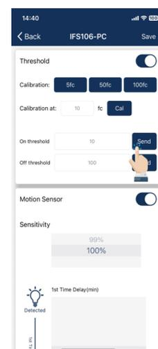
3. También puede introducir manualmente el umbral de encendido/apagado y seleccionar el botón “Enviar” para establecer el valor en el sensor sin calibración.
